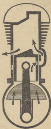
FIG. 10. — Trajet des gaz dans un moteur à 2 temps durant la montée puis la descente du piston.
