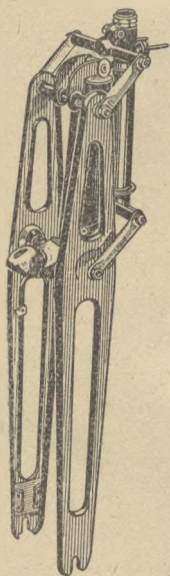
FIG. 34 (ci-dessous). — La fourche élastique la plus répandue est à parallélogramme déformable, constitué par les axes pivotants reliés par les bielles, avec ressort central de suspension travaillant à la compression. N'oubliez pas de graisser souvent ces axes
